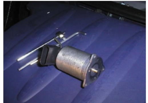
Aktuator ausbauen, drei Schrauben lösen, die untere ist etwas fummelig.
