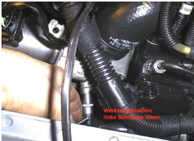
beide Flanschschrauben lösen
