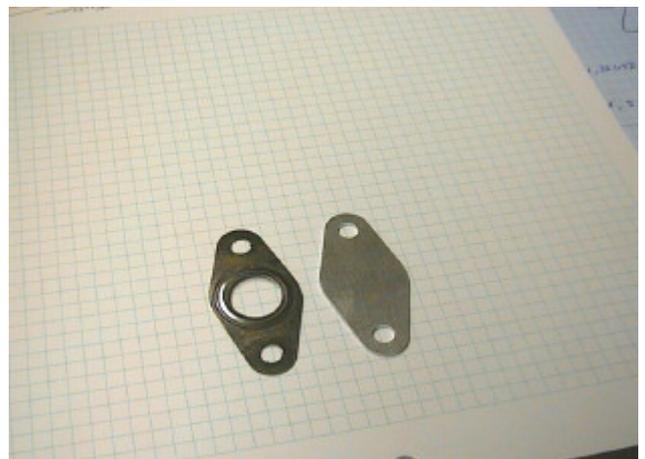
mit dickem flachen Schraubendreher das Flanschrohr etwas abdrücken und die Scheibe rausnehmen. Rechtes Bild zeigt links die alte und rechts die neue Scheibe.
